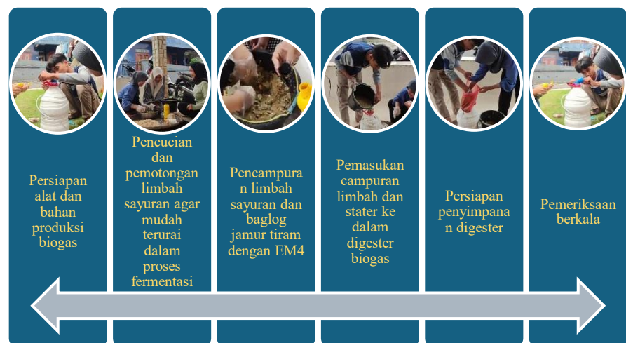
Gambar 1. Alur Cara Kerja Pembuatan Biogas
